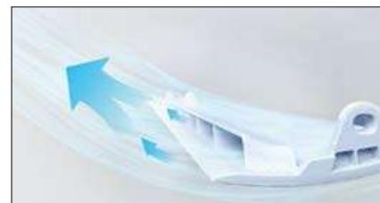
Воздушный поток под воздушным дефлектором подхватывается отрицательным давлением, создаваемым более быстрым промежуточным воздушным потоком, и соединяется с основным воздушным потоком, усиливая его.
