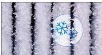
Благодаря установке оптимальной температуры испарения и объема циркуляции воздуха, влажность на замораживаемой поверхности увеличивается на 30 % по сравнению с традиционными моделями. Иней на поверхности создает мощную силу холодного расширения для легкой очистки от грязи.
