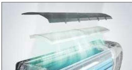
Super-IFD фильтр, (англ. Intense Field Dielectric) представляет собой композитный блок из полых каналов для протока воздуха, «пол» и «потолок» которых имеют противоположные электрические заряды. Взвешенные в воздухе, предварительно заряженные частицы очень эффективно улавливаются таким фильтром. Блок состоит из 61004 вентиляционных каналов, а их суммарная площадь, на которой осаждается пыль, составляет 8,78 м<sup>2</sup>.
